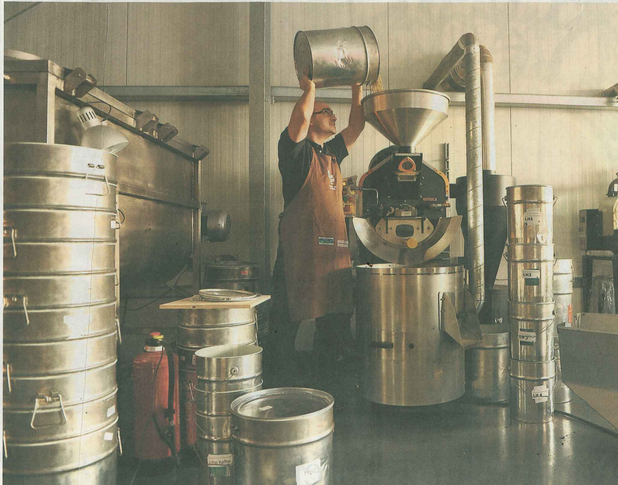
Chargenbetrieb: Wie in fast allen Kleinröstereien wird auch bei Rosario Bonafede der Robkaffee in einer „Heiztrommel“ langsam und damit schonend auf Temperatur gebracht.
