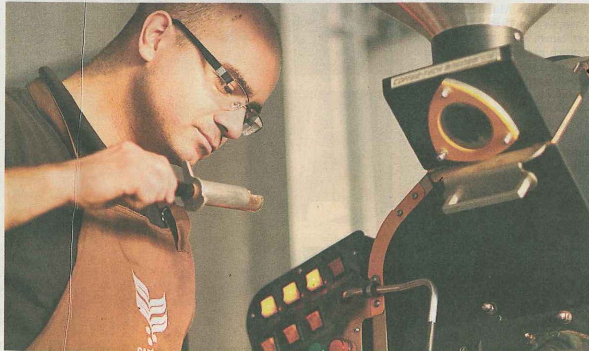
Probe aus dem Röster: Der Röstprozess lässt sich nur schwer automatisieren. „Zwischenprüfungen“ sind erforderlich.
